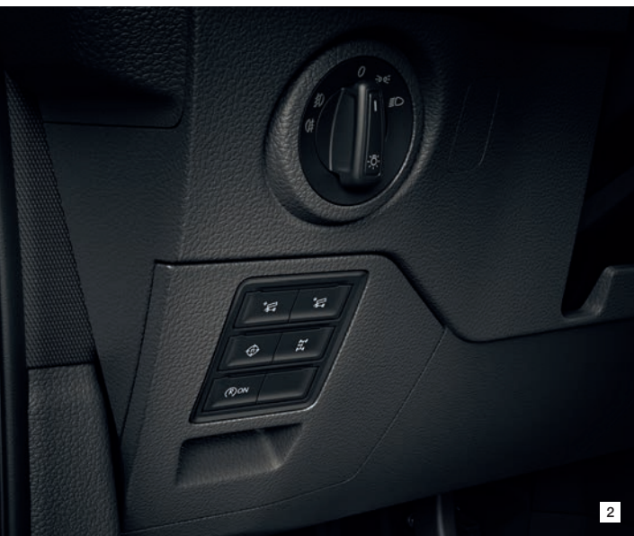
1 – Dobbeltkabine (tilgængelig i forskellige køretøjslængder- og højder); 2 – Separat kontrolpanel der kan betjenes fra førersædet eller uden for køretøjet; 3 – Bugseringskøretøj
